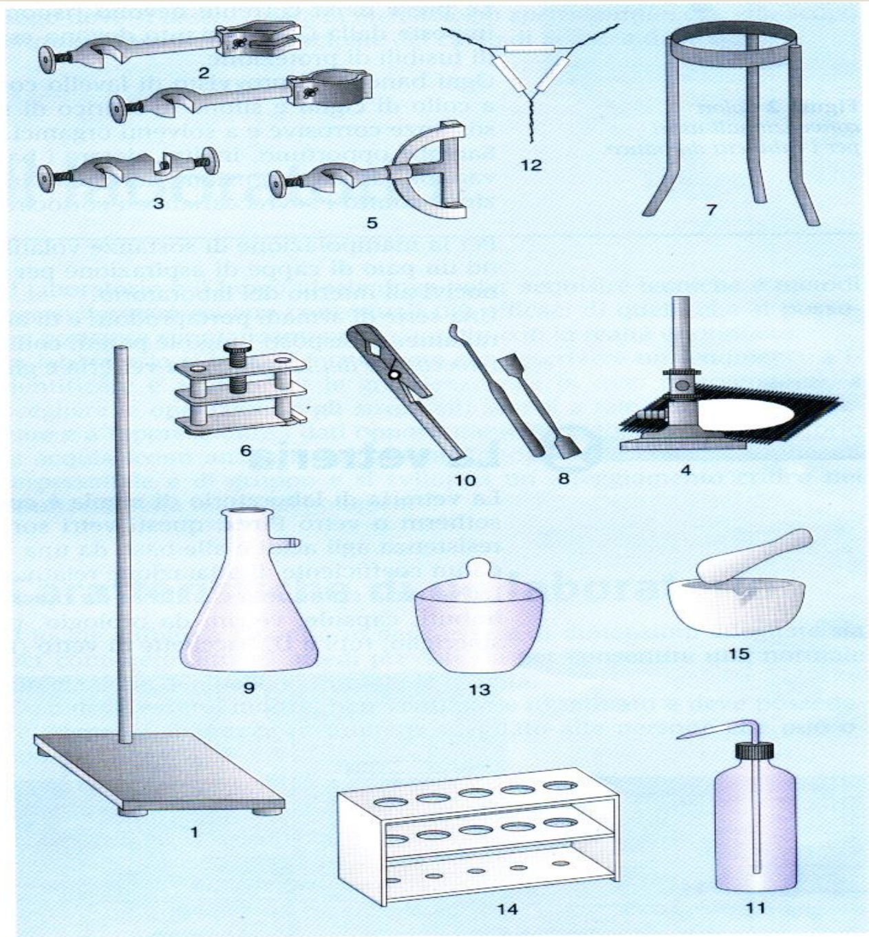
Figura 4 1. sostegno; 2. pinze; 3. morsetto; 4. becco Bunsen e reticella; 5. pinza per buretta; 6. pinza di Mohr; 7. treppiedi; 8. spatole; 9. beuta da vuoto; 10. pinza per provette; 11. spruzzetta; 12. triangolo; 13. crogiuolo con coperchio; 14. portaprovette; 15. mortaio con pestello di porcellana.
